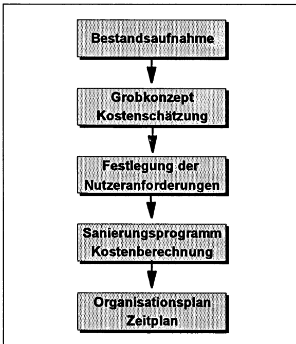
Abb. 27 Planungsschritte einer Sanierung
