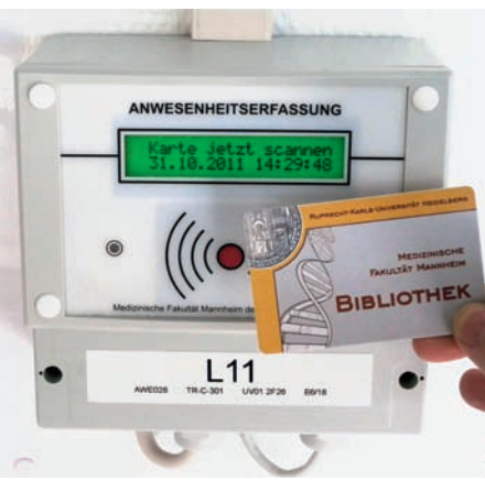
Abb. 1 In den Räumen fest montierte Anwesenheitserfassungsbox
