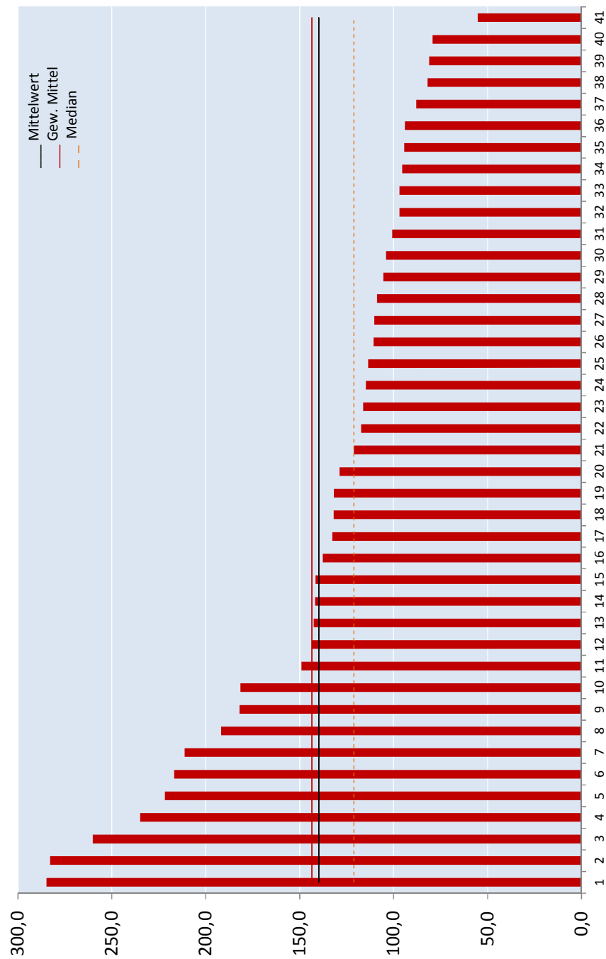
Abb. 3.3-29 Gesamtauswertung flächenbezogener spezifischer Wärmeverbrauch (U-TU-ME-FZ [kWh/m² NGF])
