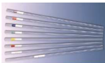
Verschweißbare „Straw“ Probengefäße
