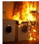
Im Brandversuchshaus des IFS wurde ein Video zu einem Wäschetrocknerbrand gedreht. [Video](#) und [Diashow](#) zeigen in beeindruckender Weise die Geschwindigkeit des Geschehens.
